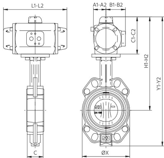
MND - 2-činný pneumatický pohon / double acting pneumatic actuator
