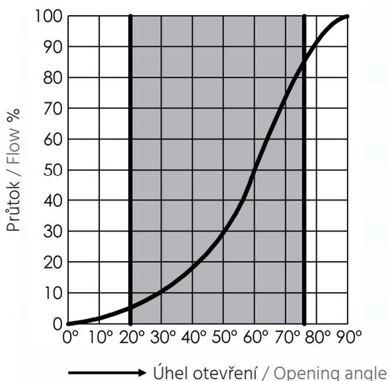
Uzavírací klapky se používají pro uzavírání průtoku nebo hrubou regulaci průtoku. Regulace průtoku má smysl pouze v rozmezí 20°–75° úhlu otevření disku, musí se brát zřetel na limity armatury a dodržet příslušné průtokové rychlosti (pro kapaliny  $\leq$  4  $m/s$ , plyny  $\leq$  40  $m/s$ ), aby nedocházelo k vibracím, kavitaci a nadměrnému hluku.
