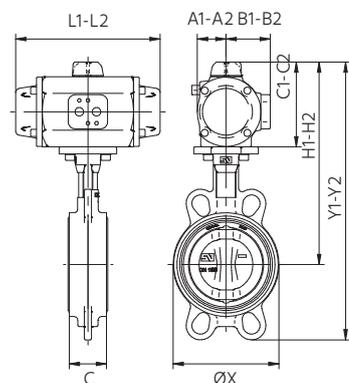
MND - 2-činný pneumatický pohon PRISMA / PRISMA double acting pneumatic actuator
