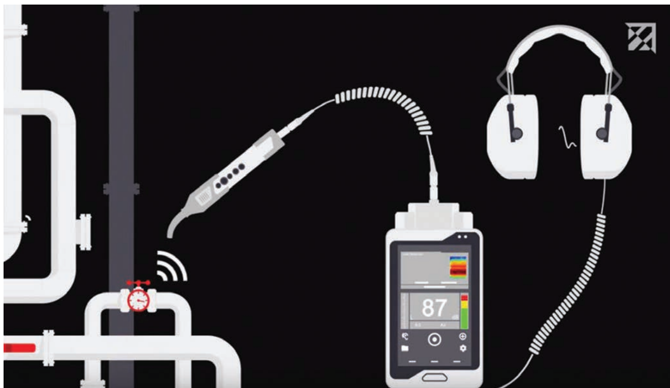
Obr. 10 – princip detekce netěsnosti ultrazvukem
